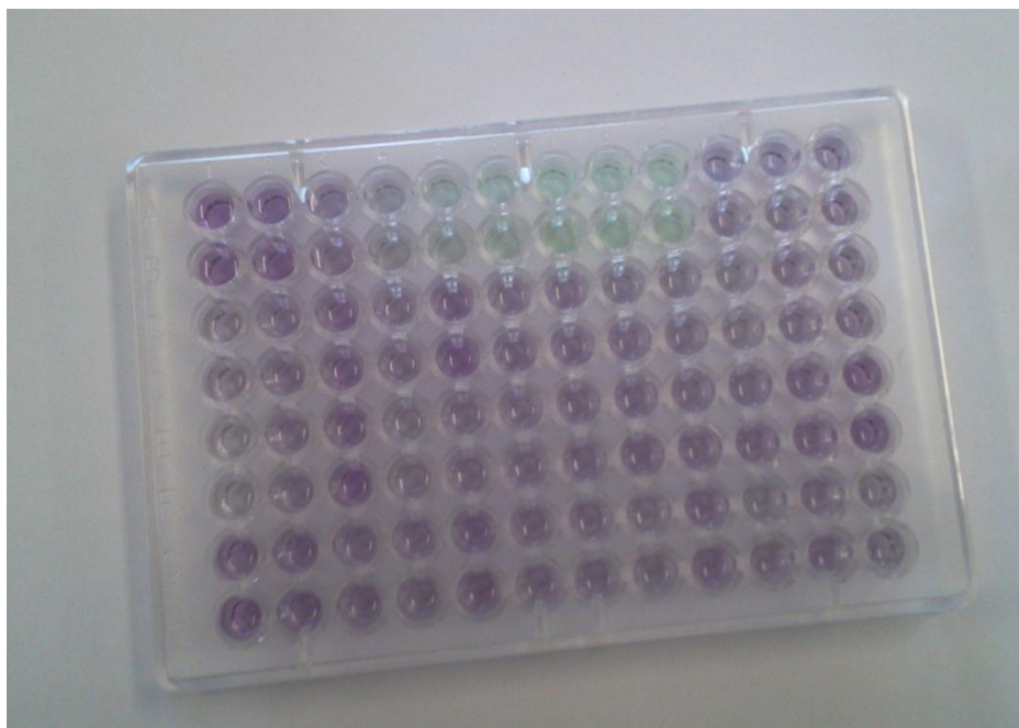
Příloha 8. Destička BCA testu po inkubaci, připravená na kvantifikaci proteinů ve spektrofotometru.
