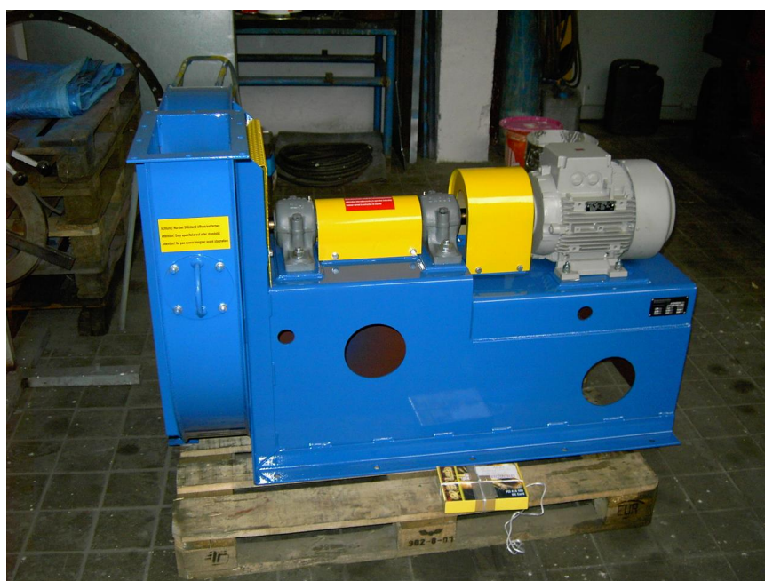
Příloha 7: Radiální ventilátor s pohonem na spojku
