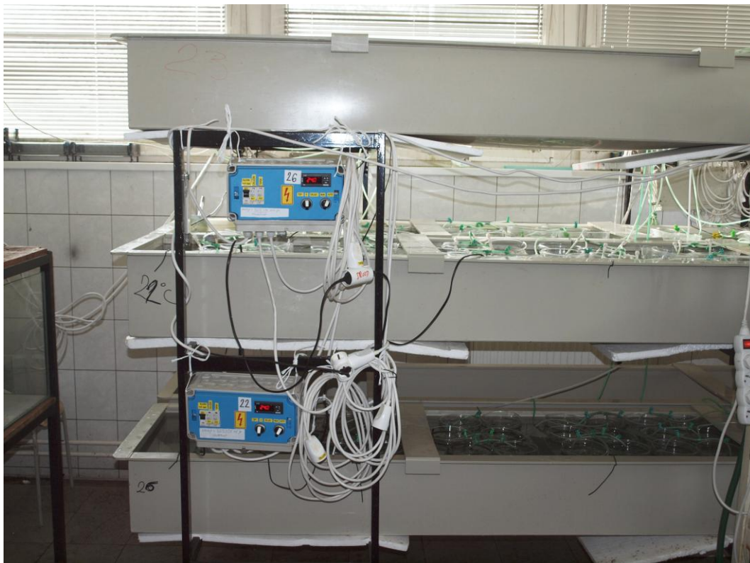
Příloha č. 6: Pokusný systém skládající se z 3 žlabů s odchovnými kádinkami a jedním žlabem se zásobní vodou (Foto: autor BP)
