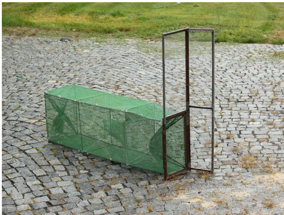
Obr. 10 Vrš pro kontinuální odlov protiproudově migrujících ryb rybím přechodem (Foto: autor).
