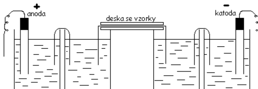
Obr.4.: Základní uspořádání plošné elektroforézy
