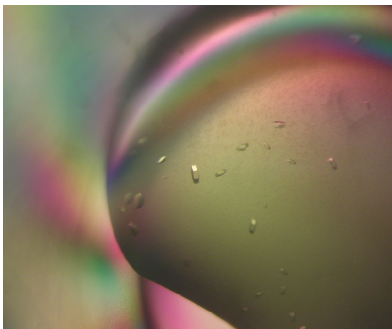
Obrázek 12. Menší monokrystaly LinB32 – krystaly narostlé při krystalizačních podmínkách 0.2 M KNO 3 , 25% PEG 3350 za použití metody sedící kapky (foto autor)
