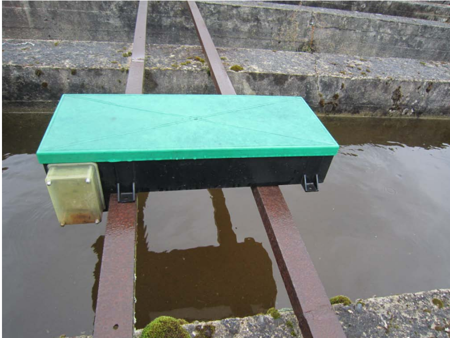
Obr. 7: Pohled na krmítko s hodinovým strojkem
