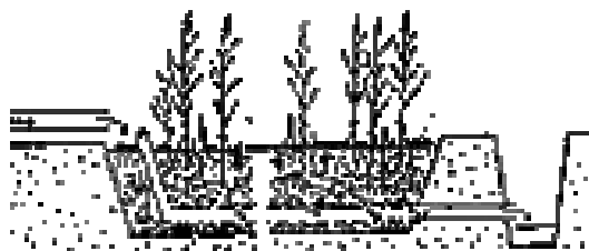
Obrázek č.3: Umělý mokřad s podpovrchovým vertikálním tokem (Vymazal, 2005)
