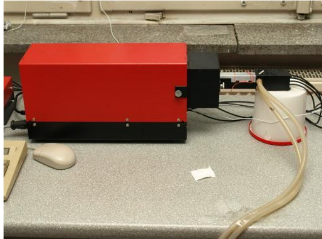
Světelná pipeta jako zdroj světelného záření. Kyveta je uložena do nástavce světelné pipety.
