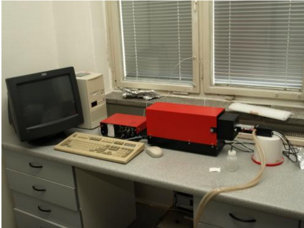
Zařízení Illuminova. Počítačem řízený simulátor sloužící k měření fotosyntetické aktivity.
