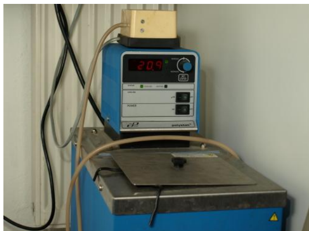
Chladicí zařízení. Rezervoár pro vodu, ze kterého voda proudí do pláště měřicí kyvety.
