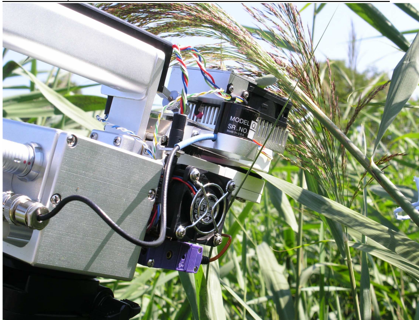
Obrázek č. 6: Měření transpirace a fotosyntézy rákosu obecného pomocí přístroje LI-COR 6400, na kořenové čistírně ve Slavošovicích dne 7.8. 2007
