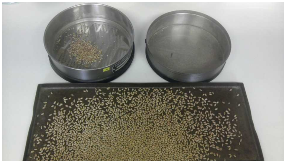
Foto č. 7. Měření obsahu příměsí a nečistot - síta (SMEJKAL, 2013)
