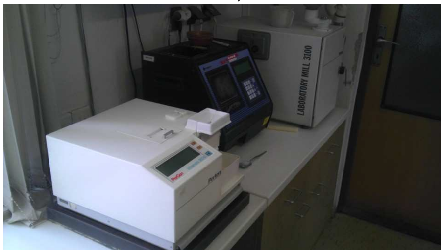
Foto č. 9. Inframatic 8600, vlhkoměr GAC 2100, laboratory mill 3100 (SMEJKAL, 2013)
