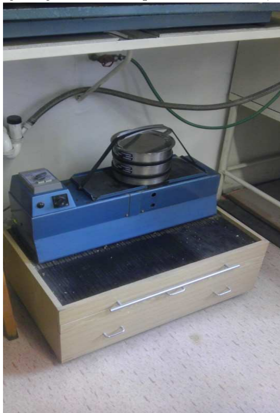
Foto č. 6. Přístroj na zjištění obsahu příměsí a nečistot (SMEJKAL, 2013)
