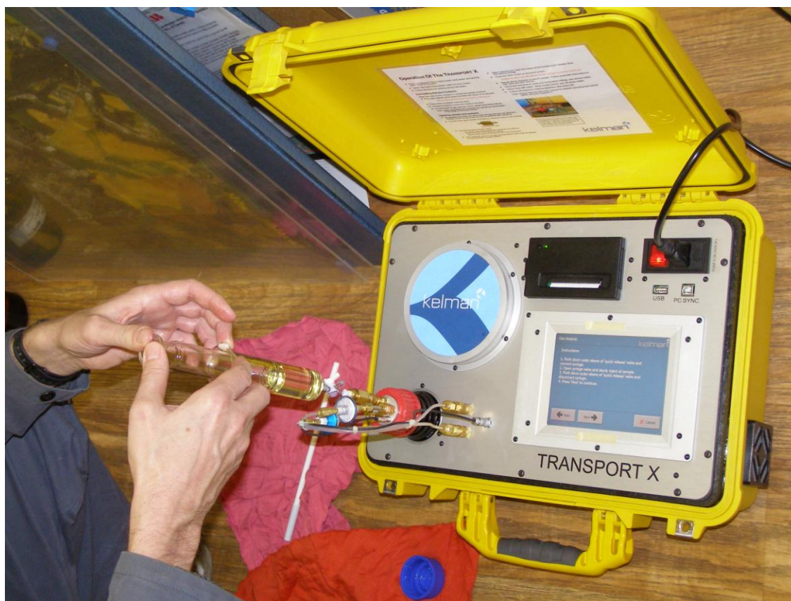
Obrázek č.12 Vstřikování vzorku oleje do zásobníku analyzátoru
