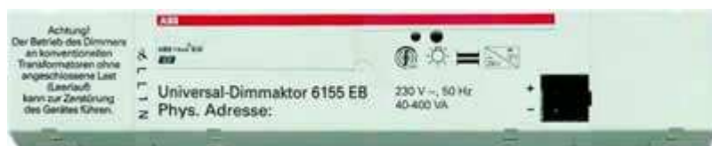
Obr. č. 12 Stmívací akční člen 6155 EB pro montáž do podhledů nebo svítidel
