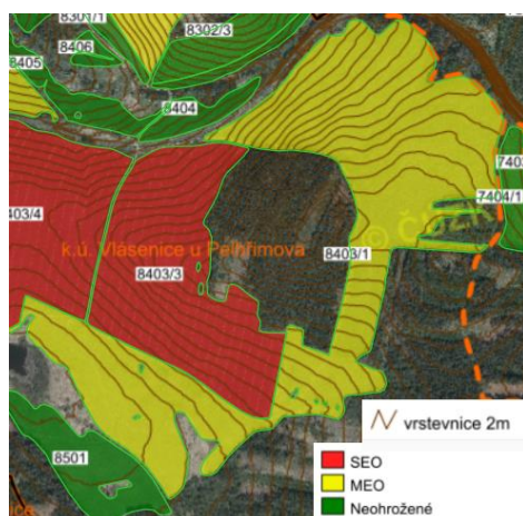
Obrázek 13: Vrstevnice s barevným označením eroze (vlevo), odtokové linie pozemku (vpravo) - pozemek 8403/1 (LPIS, 2016).
