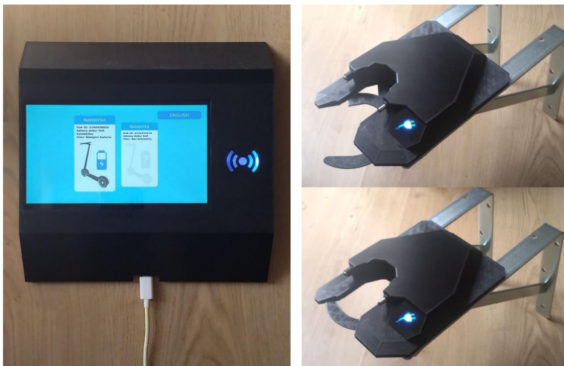
Obrázek 3 - Nabíjecí stanice (vlevo) a dok v otevřeném i zavřeném stavu (vpravo)
