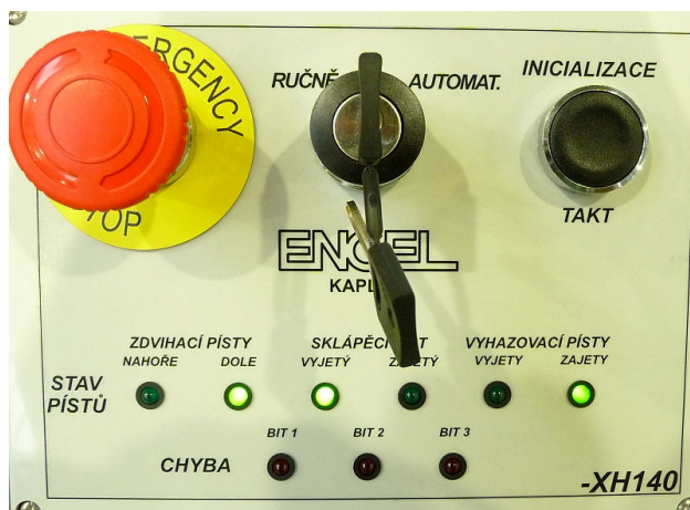
Obr. č. 49 Krabice s ovládacími prvky a signalizací (interní dokumentace firmy Engel)
