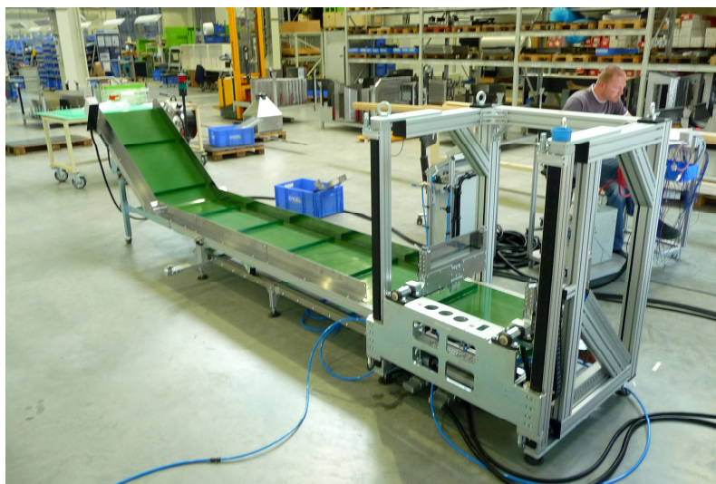
Obr. č. 51 Kompletní sestava odbíracího zařízení včetně dopravníku (interní dokumentace firmy Engel)
