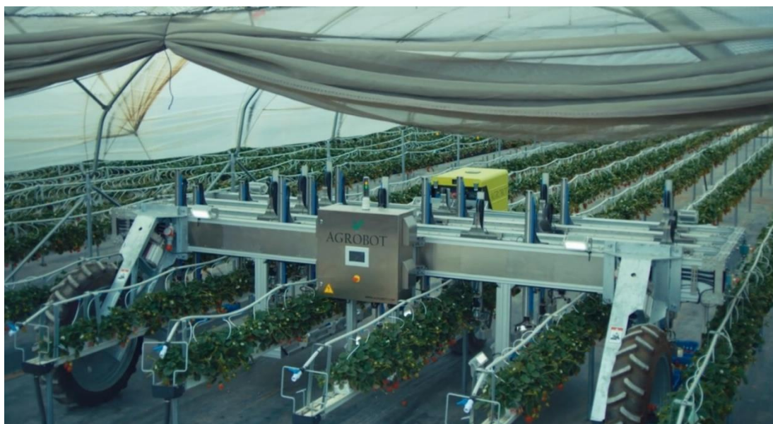
Obrázek 1.22: Autonomní robotické zařízení pro sběr jahod Agrobot (Agrobot.com, 2023) - upraveno
