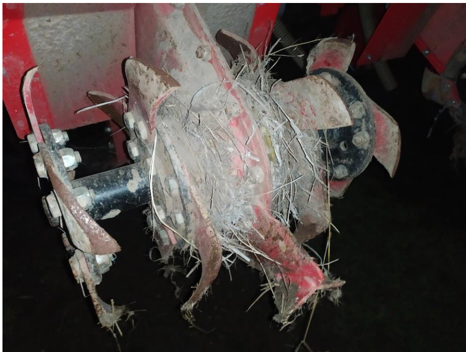
Obrázek 4.7: Ucpání pracovních orgánů plečky Özdöken ACM-SFG3 s opotřebenými noži
