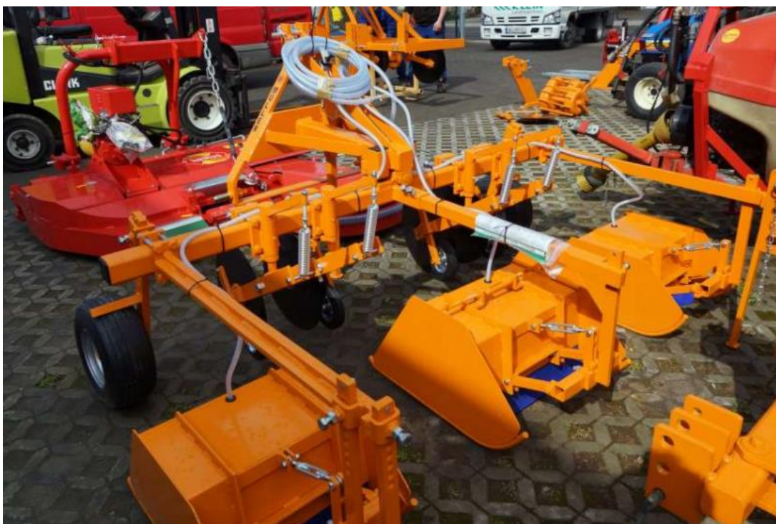
Obrázek 1.19: Meziřádkový aplikátor postřiku s ochrannými kryty pro jahodník výrobce Müller & Sohn (Kříž, 2017)
