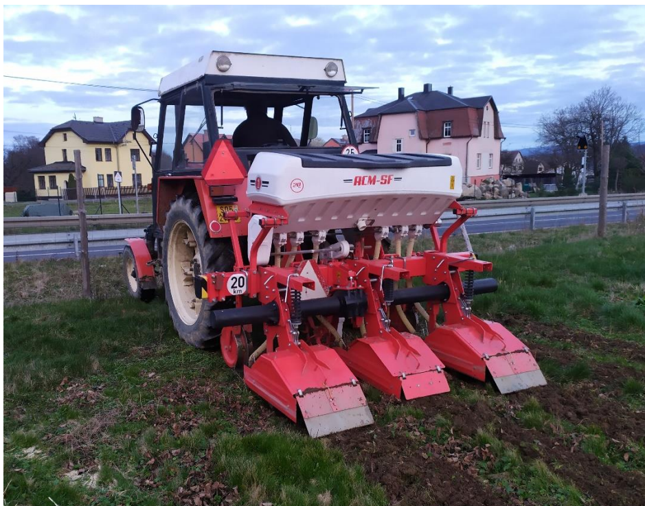
Obrázek 3.1: Özdöken ACM-SFG3 v agregaci s traktorem Zetor 7211, Jahodárna Hroznětín
