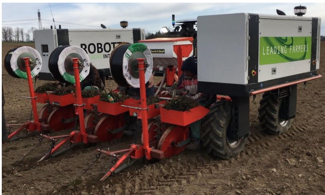
Obrázek 1.17: Precizní výsadba jahod robotickým zařízením Agroboti Robotti 150D (Němec, 2022)
