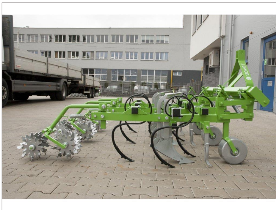
Obrázek 1.12: Plečka Bomet Norma P475/3 s dlátovitými radličkami a drobicími válci (bovram.cz, 2023b)
