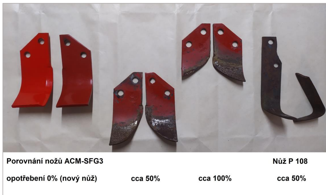
Obrázek 4.6: Porovnání opotřebení nožů rotační plečky
