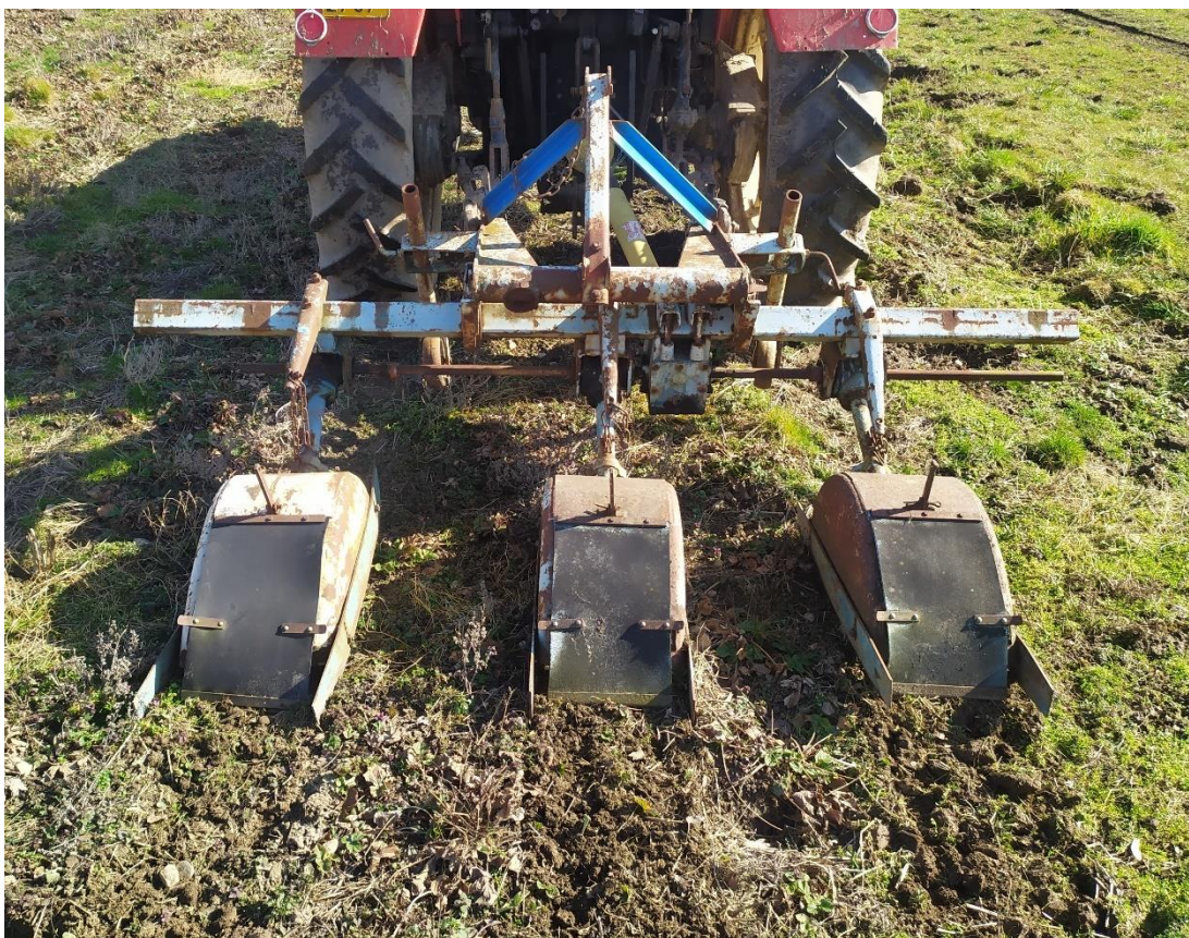
Obrázek 3.3: Rotační plečka VEB Landamaschinen Torgau P 108 s traktorem Zetor 7211, Jahodárna Šabina
