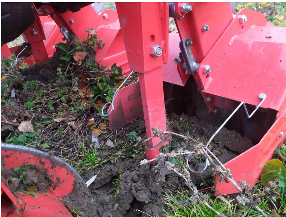
Obrázek 4.4: Poškození porostu jahod vlivem prostřední šípové radličky Özdöken ACM-SFG3 Plečka značky Özdöken se v praxi velmi osvědčila a kvalita odváděné práce je na vysoké úrovni, zvláště pak při optimálních půdních podmínkách.
