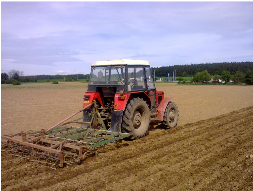
Obrázek 1.5: Kypření půdy radličkovým kypřičem - Jahodárna Staňkov
