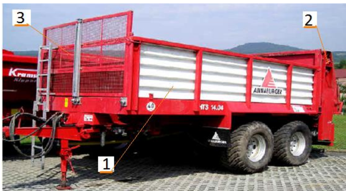
Obrázek 2.4 Rozmetadlo s lopatkovým rozmetacím ústrojím: 1. Ložný prostor, 2. Rozmetací zařízení, 3. Průhledné přední čelo
