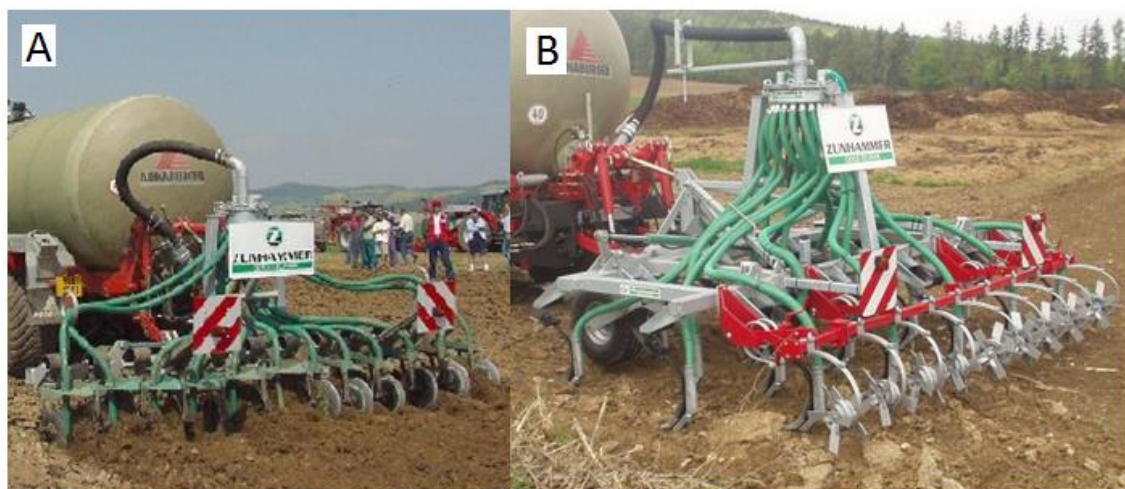
Obrázek 2.14. Aplikátory pro aplikaci kejdy: A – Talířový, B – Radličkový.
