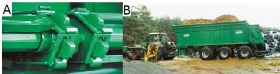
Obrázek II.5 Nástavby Tebbe: A – podlahový dopravník s plochým řetězem, B – Velkoobjemová nástavba se základním pásovým dopravníkem.
