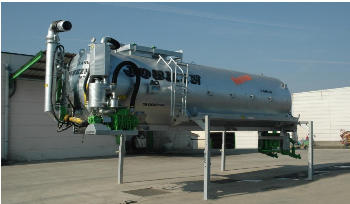
Obrázek 2.1. Výměnná nástavba cisterny Joskin na odstavných nohách
