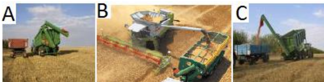
Obrázek 2.15. Překládací nástavba: A – Rozkládání vykládacího šnekového dopravníku, B – Plnění vozu sklízecí mlátičkou, C – Překládací nástavba místo zadního čela sklápěcí korby.
