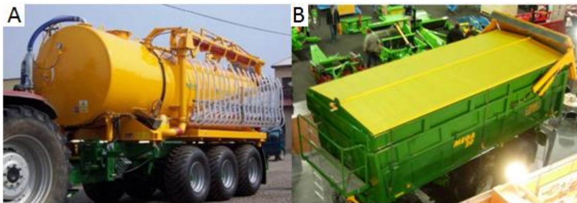
Obrázek II.6.: nástavby ZDT: A – cisterna s aplikátorem kejdy v přepravní poloze, B – nástavba překrýtá natahovací plachtou
