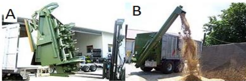
Obrázek 2.16. Výměnné čelní nástavby Fliegl: A – Výměna rozmetací nástavby vysokozdvížným vozíkem, B – Překládací nástavba.
