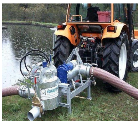
Obrázek 2.9. Rota – Cut: 1. Těleso Rota – Cutu, 2. Homogenizační nože, 3. Síto, 4. Hydromotor, 5. Přívod, 6. Přívod k čerpadlu
