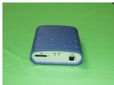
Obr.č.6. modem GPRS ER 75
