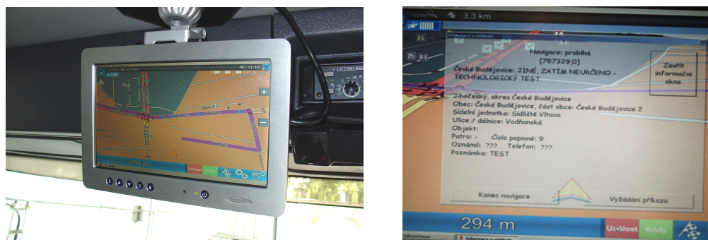
Obr.č.9. Ukázka monitoru ve vozidle: vlevo trasa, vpravo přijaté informace o události (foto: autor)
