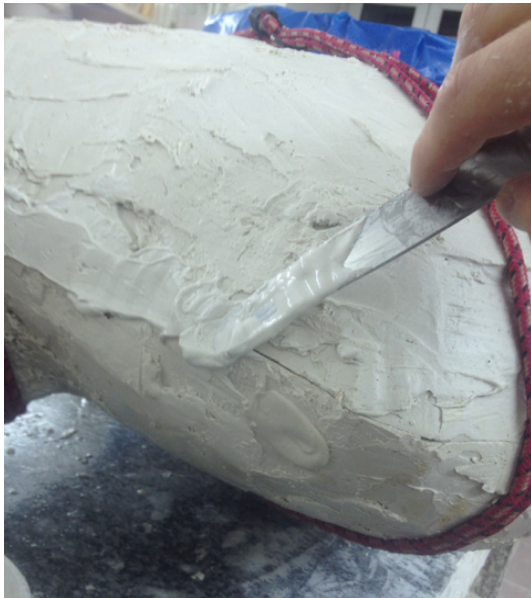
Obr. 50: Zakrytí dělicí mezery sádrou.
