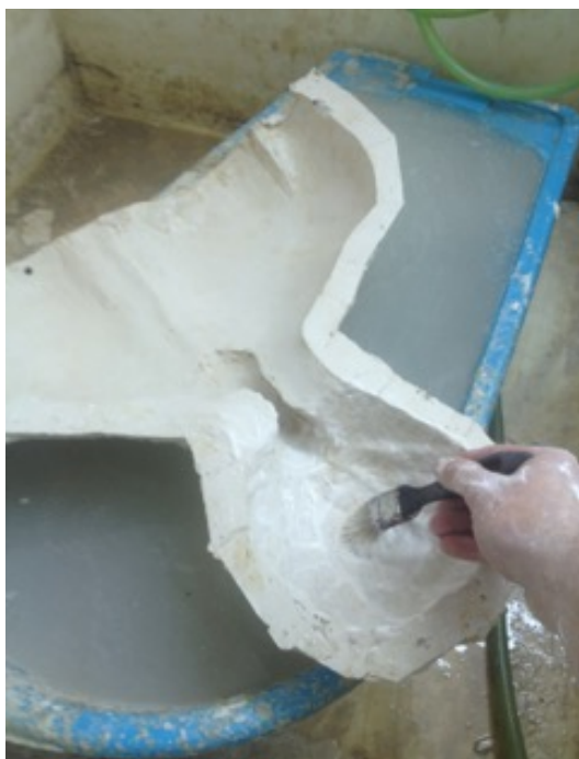
Obr. 48: Nanášení separačního nátěru.
