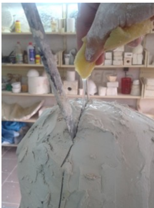
Obr. 43: Opatrné rozebírání formy pomocí nožů a vody.
