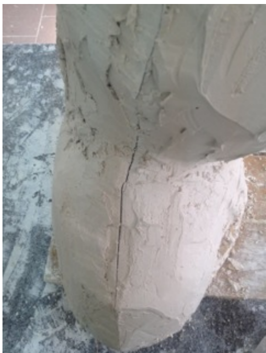
Obr. 42: Očištění dělicí roviny.
