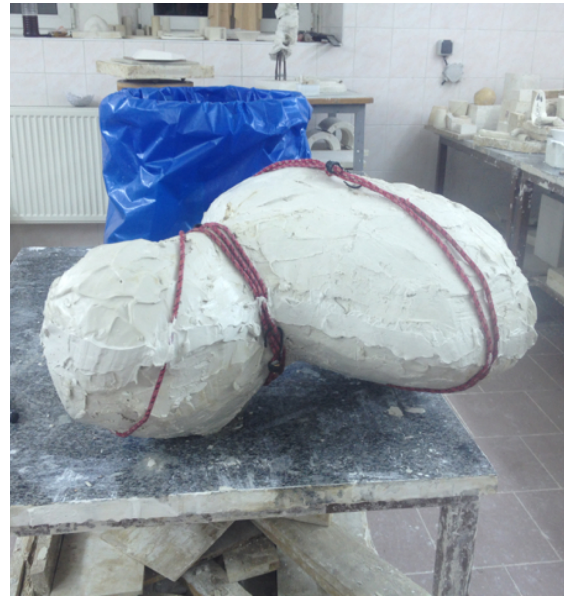
Obr. 51: Forma pevně svázaná a připravená k nalévání sádry.
