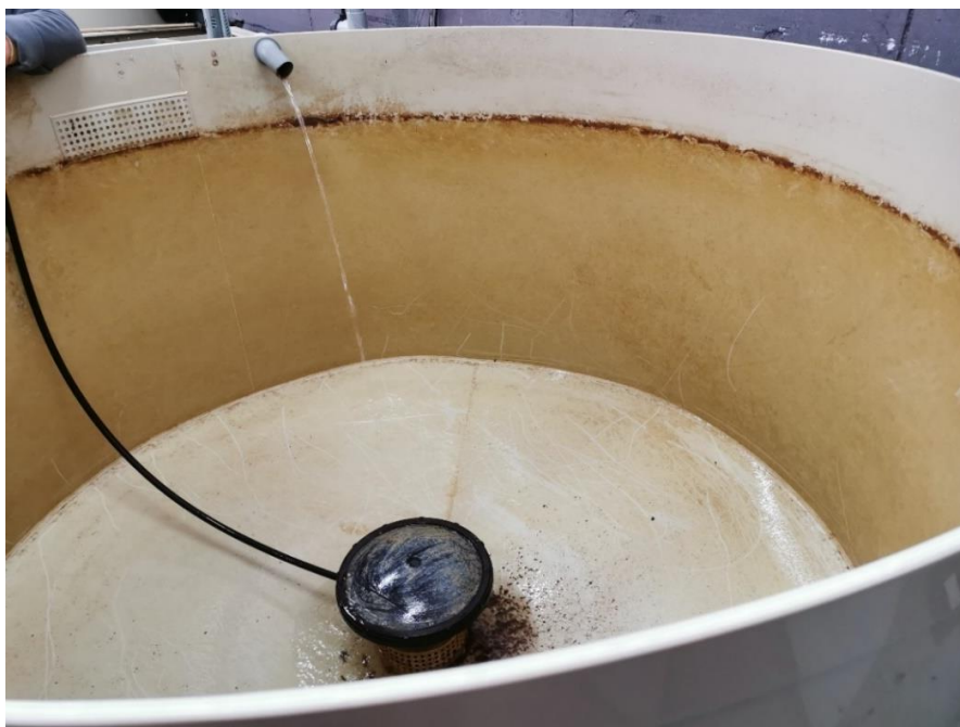
Obr. č. 31 Upravené kónické dno v optimalizovaném systému se vzduchovacím diskem (foto R. Gebauer)
