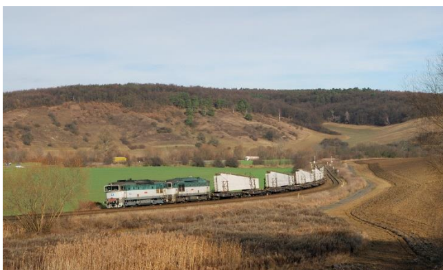
Obrázek 8 - Přeprava vazníků na JE Temelín pomocí železniční dopravy [10]
