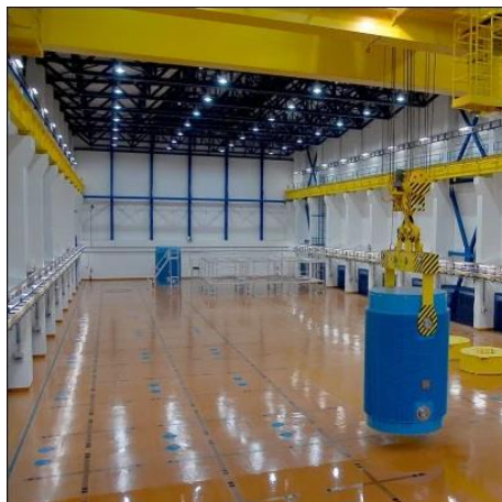
Obrázek 7 - Přeprava OS ve výšce 0,3m nad zemí v SVJP na místo uložení [2]
