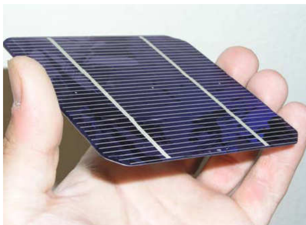
Obrázek 2 - Standardní polovodičový fotovoltaický článek na bázi polykrystalického křemíku (LIBRA a POULEK, 2009)
