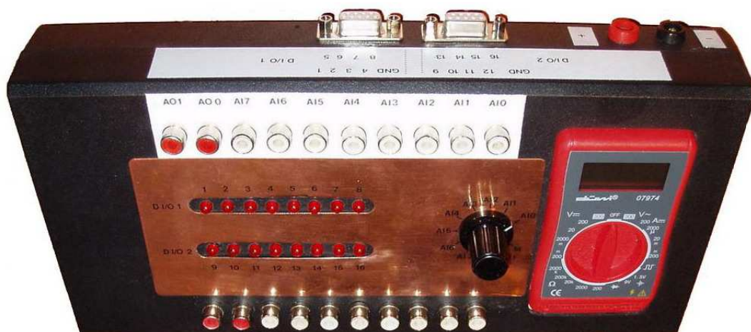
Obr.7. Zhotovené univerzální rozhraní měřících karet.
