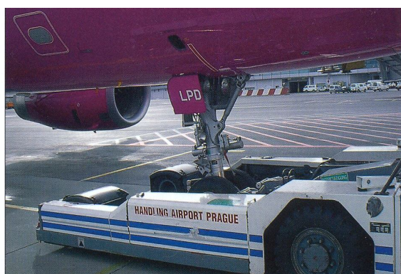
Obr. 5: Letadlový tahač s tažnou silou do 500 tun
