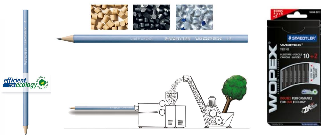
Obr. č. 65 Wopex – granulové složky, technologie výroby, výrobek [31]
