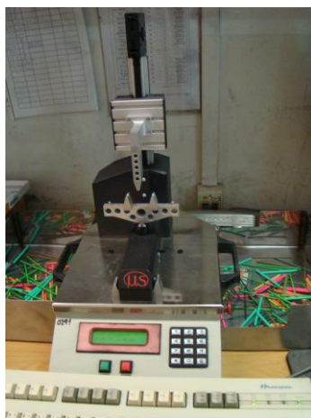
Obr. č. 95 Zkušební přístroj určující pevnost tuh
