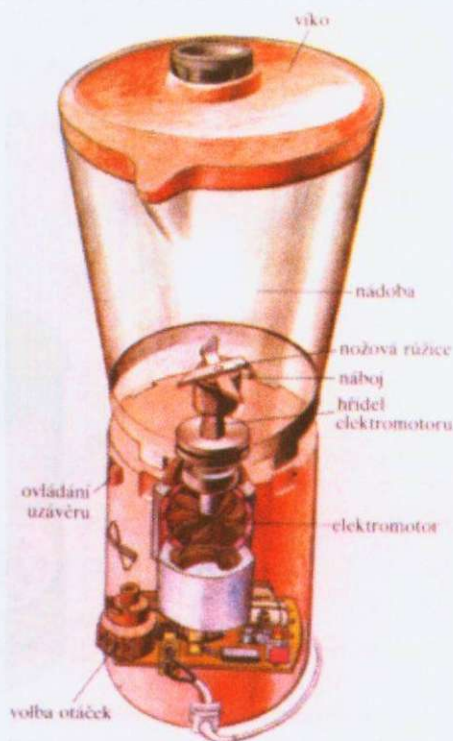
obr. 10.1 Průřez mixérem
