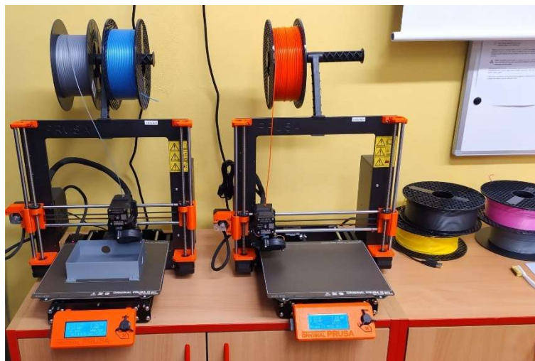
Obrázek 33: Tisk komponentů na 3D tiskárně
