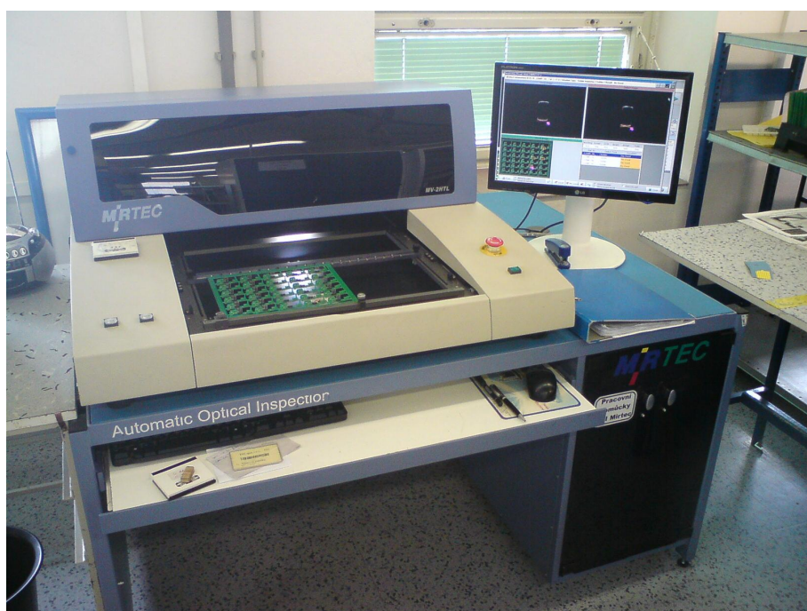
Obr. 26. Zařazení optické kontroly AOI MIRTEC MV-2HT
