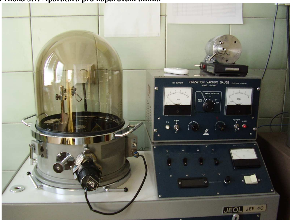
Příloha 9.1: Aparatura pro napařování uhlíku
