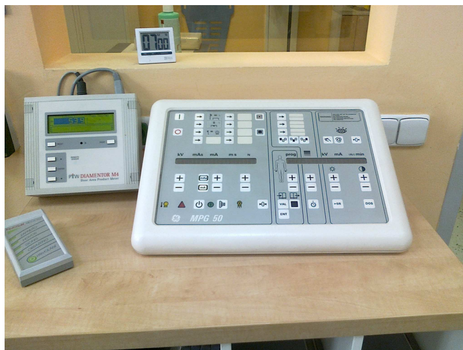
Obr. č.7 Ovládací konzole pro Compax 40E
