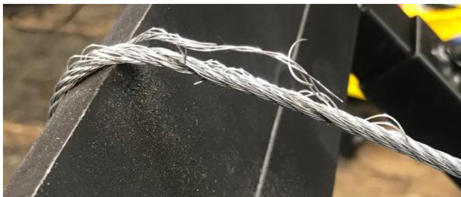
Obrázek č. 36: Ocelové lano po provedení 3920 cyklů.
