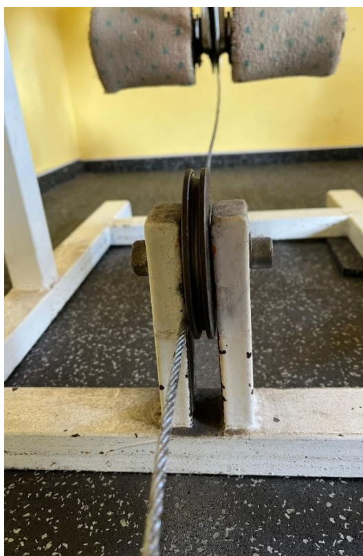
Obrázek č. 22: Špatné napnutí lana.
