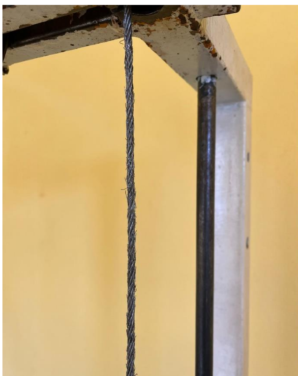
Obrázek č. 25: Otřepy vzniklé u ocelového lana.
