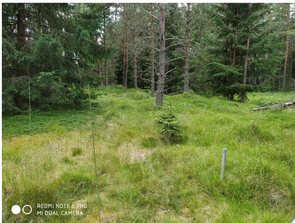
Obr. 5: Ohraničená plocha s trubicou pro měření podzemní vody (foto: autor).
