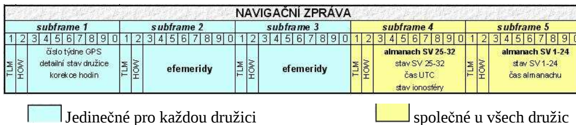
Obr.č. 6, Struktura navigační zprávy [8]
