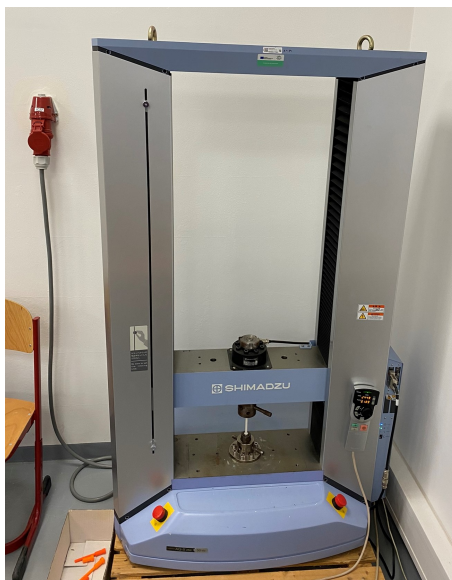
Obrázek 3.3: Univerzální trhací stroj Shimadzu AG-X Plus 50 kN
