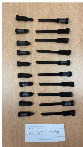
Obrázek 5.8: Roztrhané modely skupiny PETG Frost
