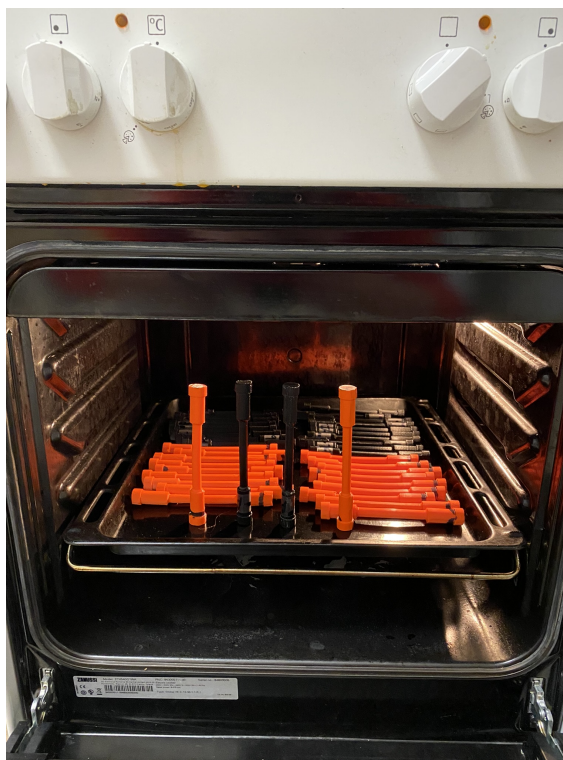
Obrázek 5.6: Umístění skupiny Heat do trouby
