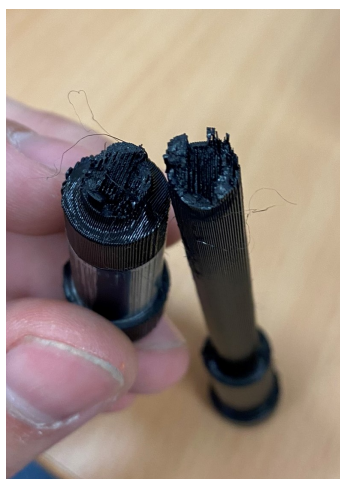
Obrázek 5.9: Detail místa roztržení
