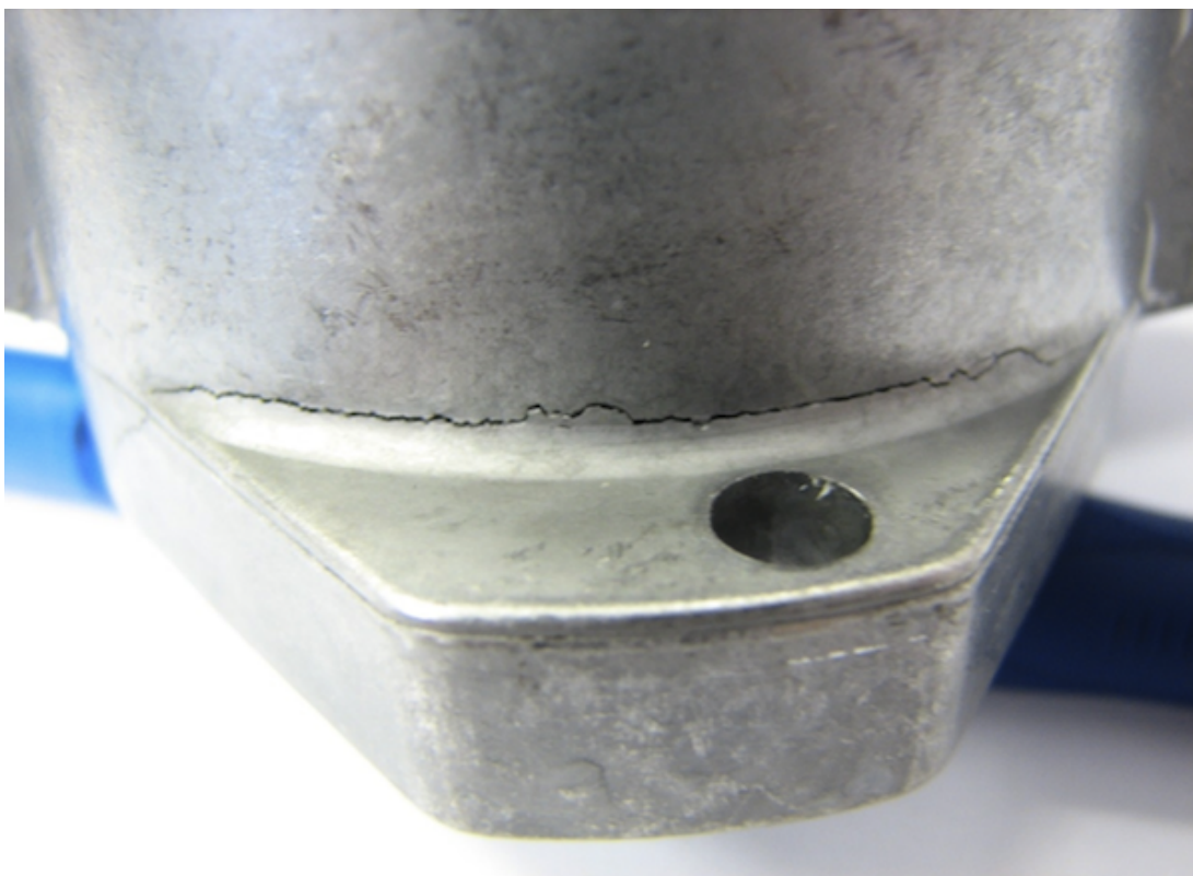
Obrázek 27: Vada odlitku, prasklina vznikla kvůli nedostatečnému mazání dutiny formy
