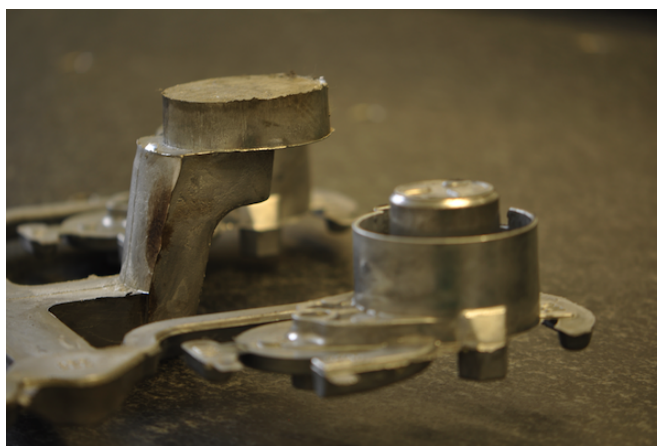
Obrázek 18: Vtok (tableta) odlitku odlitého na stroji se studenou komorou
