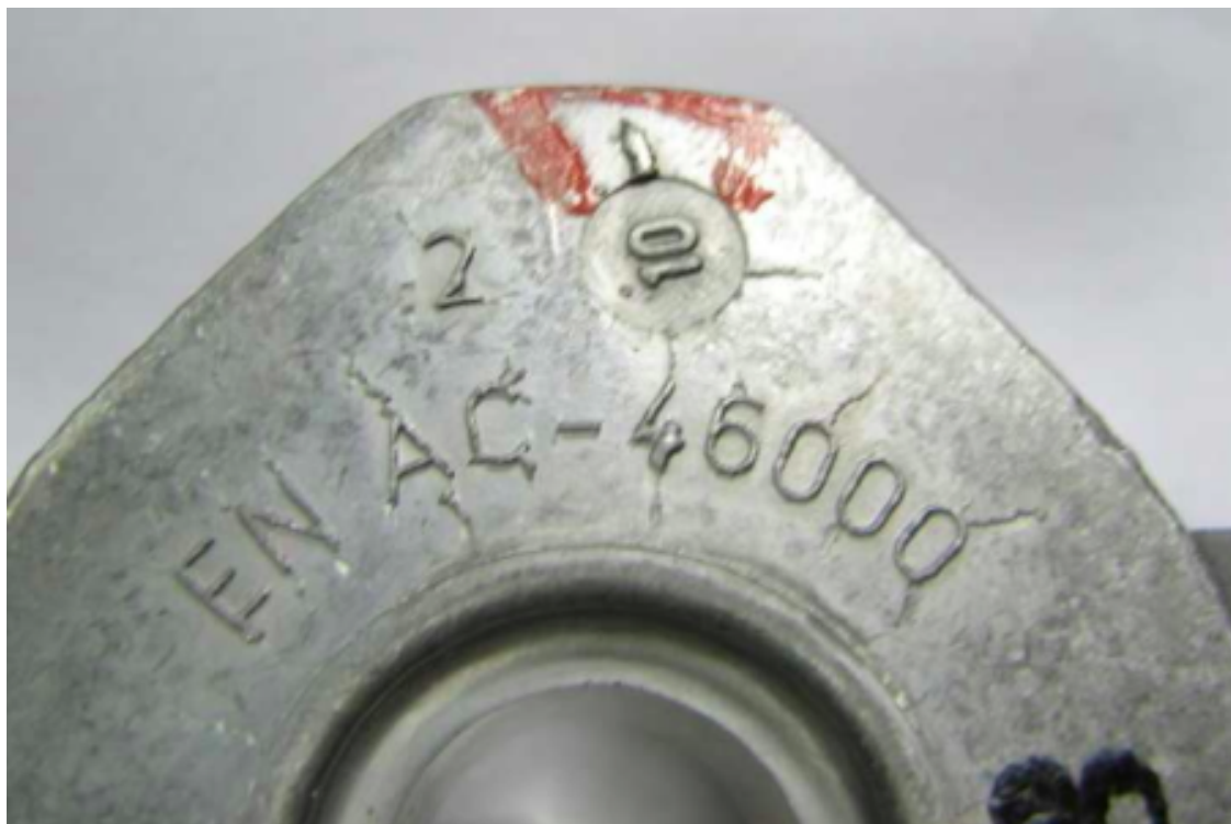
Obrázek 29: Vada odlitku, vypadlý tvar z důvodu poškození formy
