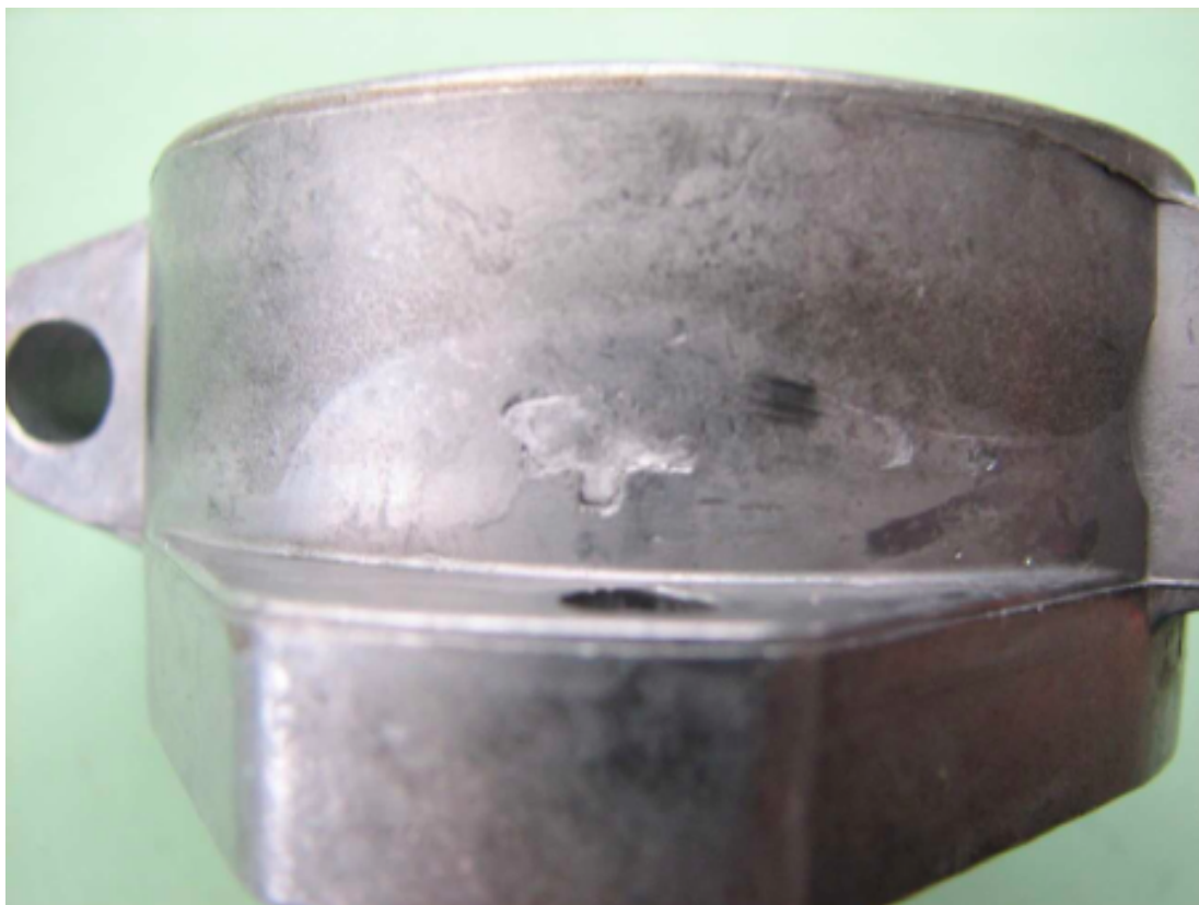
Obrázek 28: Vada odlitku, nedolitý kus z důvodu špatného seřízení ostříku
