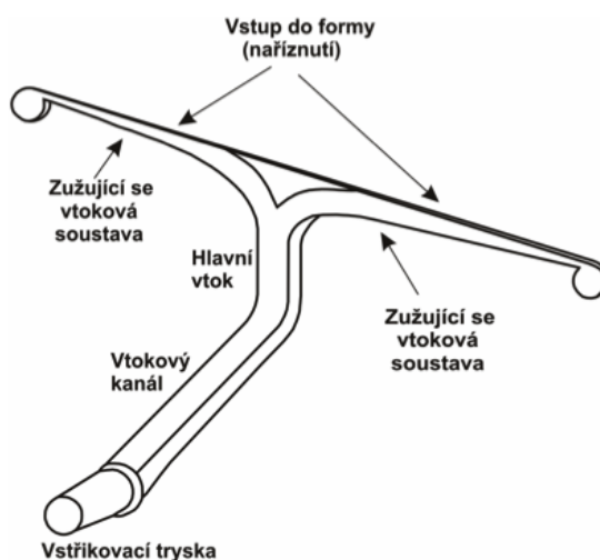
Obrázek 19: Schématické znázornění vtokové soustavy na stroji s teplou komorou, převzato z [1]
