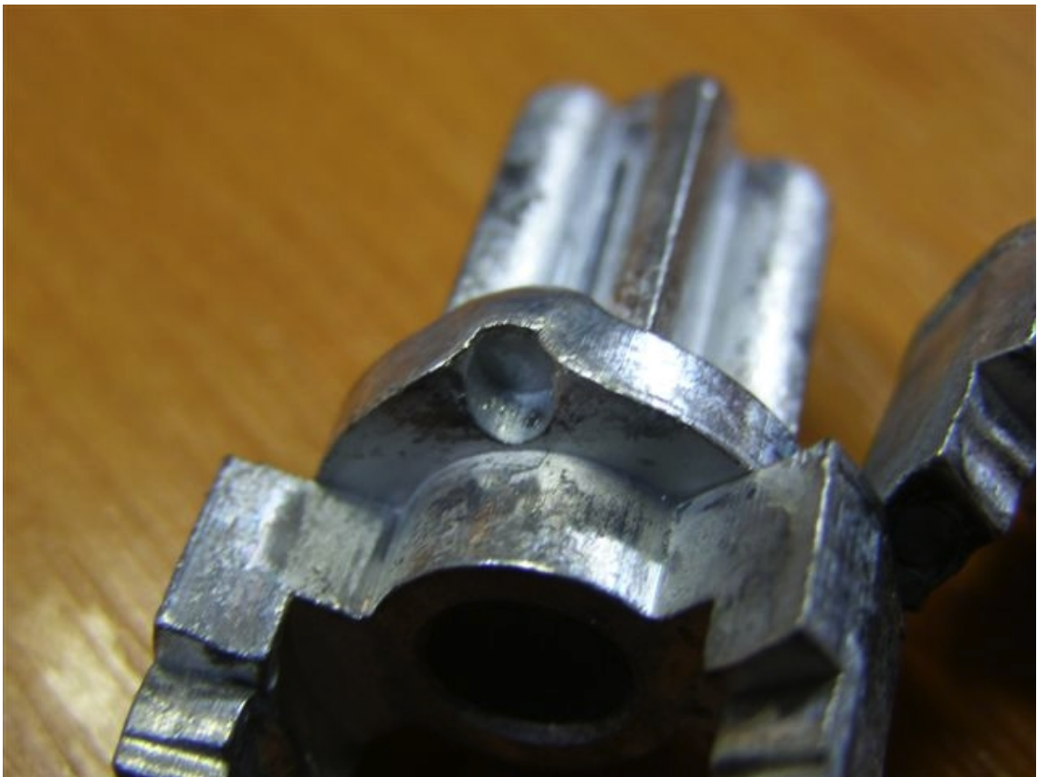
Obrázek 26: Vada odlitku, dutina vznikla kvůli špatnému seřazení vyhazovačů
