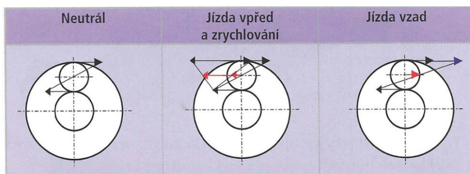
Obrázek 2.16 - Kinematika planetového převodu CVT převodovky
