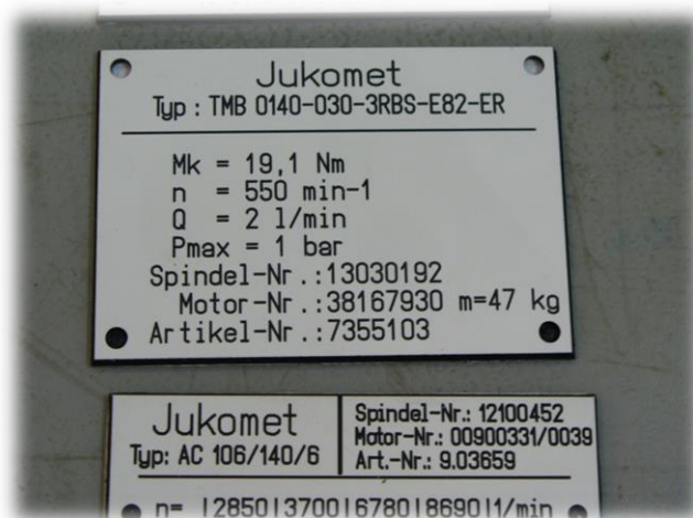
Obrázek 13: Štítek používaný k označení vřetena
