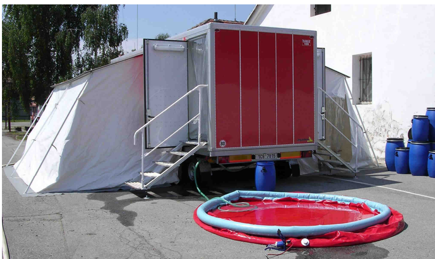
Stanoviště dekontaminace osob (SDO 2)
