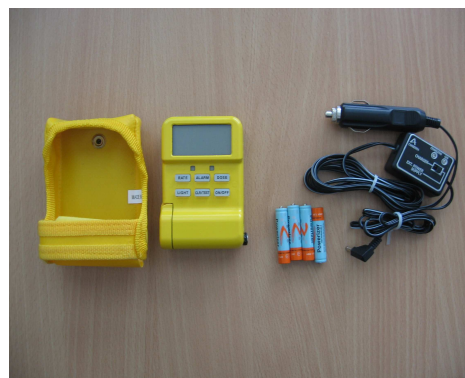
Obrázek 6: Zásahový dozimetr U-RAD 115
