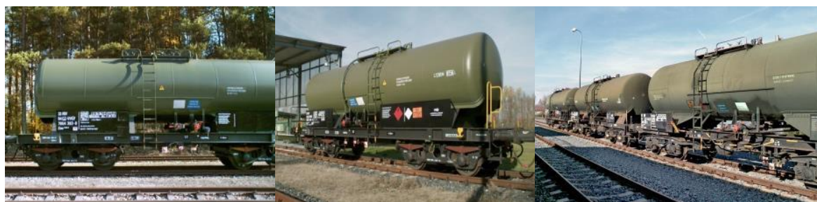
Obrázek 26: Kotlové železniční vozy
