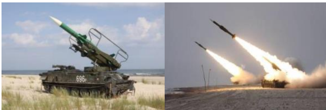
Obrázek 10: Odpalovací zařízení 2P25
