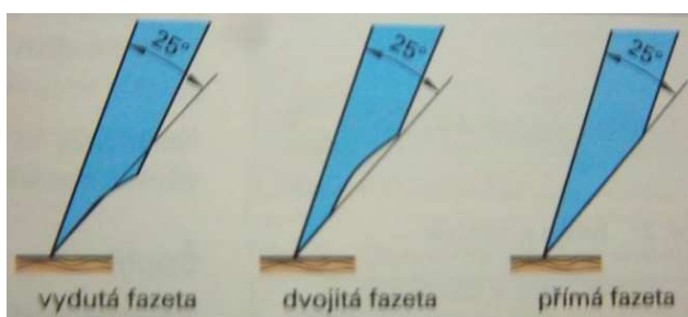
Obr. 34: Fazety u čepovacích dlát [4]
