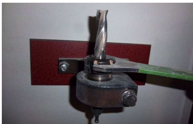
Obr.63: Upínání a výměna řezného nástroje
