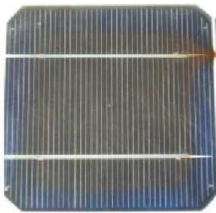
Obr. 4-7 koroze na sběrnici [8]
