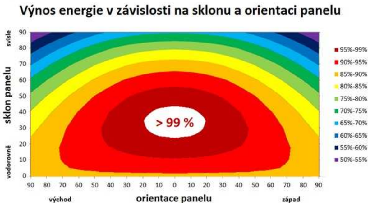
Obr. 4-9 Výnos energie v závislosti na sklonu a orientaci FV panelu [12]
