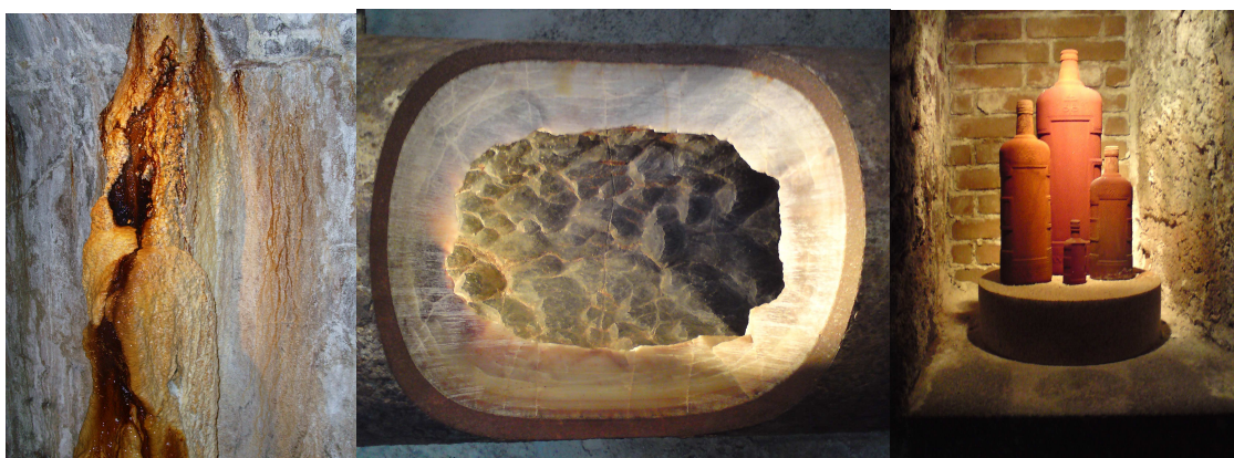
Obrázek 8: Inkrust na stěnách, zanesené potrubí a pokameněná Becherovka
