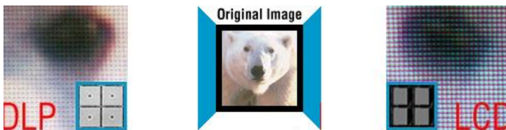
Obrázek 22: Porovnání DLP a LCD
