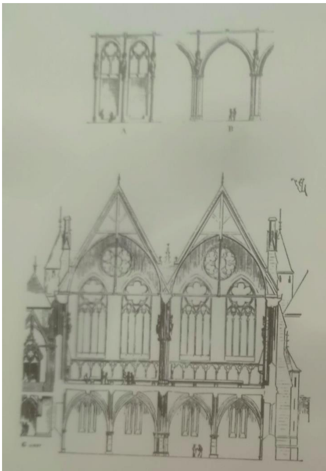
51. Rekonstrukce horního i dolního sálu paláce de la Cité podle Viollett le – Duc
