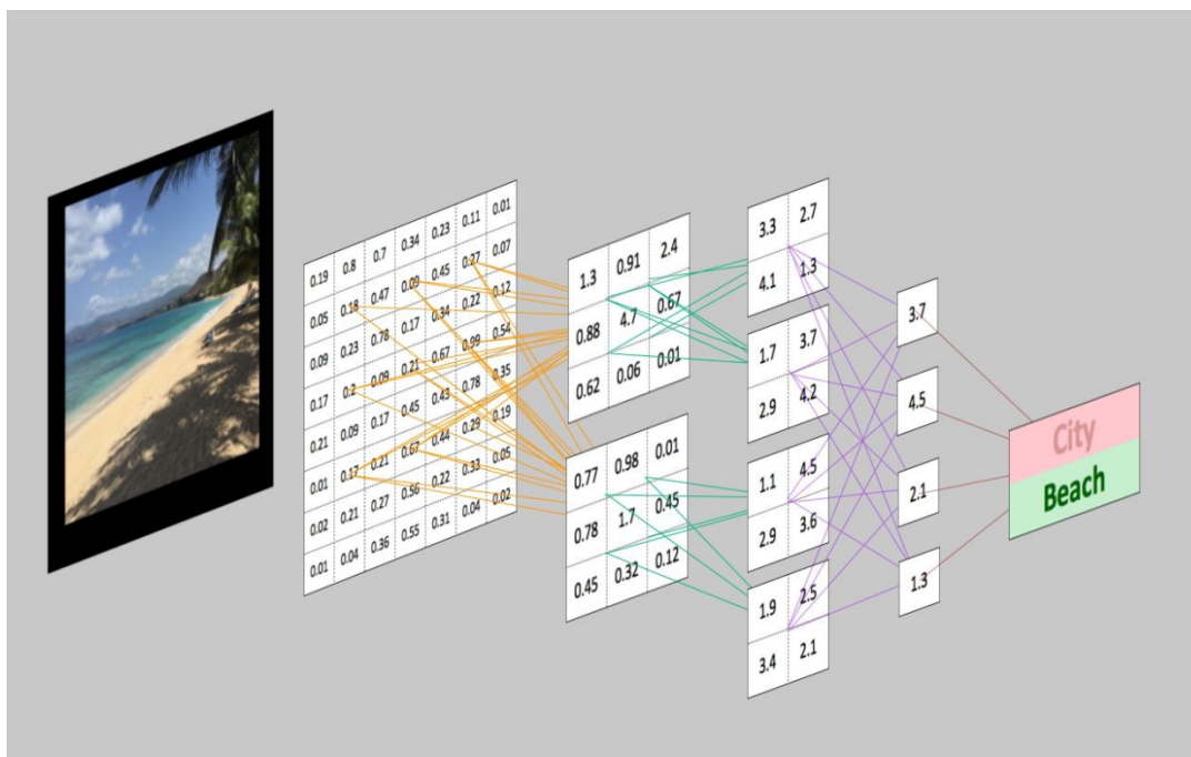
Obrázek 1.1: Rozpoznávání obrazu pomocí CNN [1]
