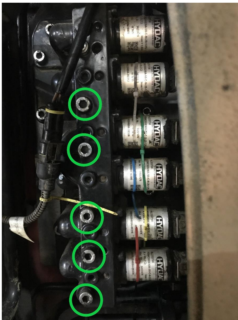
Obrázek 4.9 Měřicí body na rozdělovači tlaku na bloku převodovky
