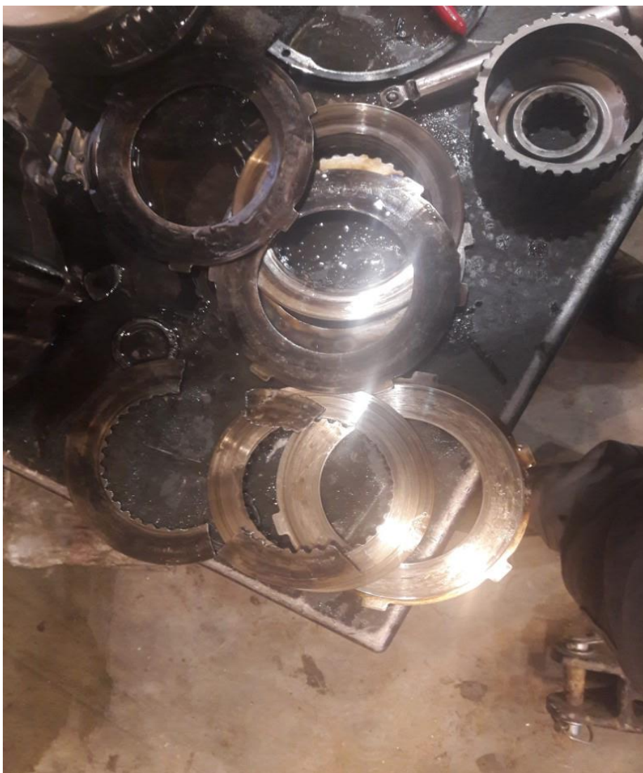
Obrázek 4.6: Spálená lamelová spojka Powershift
