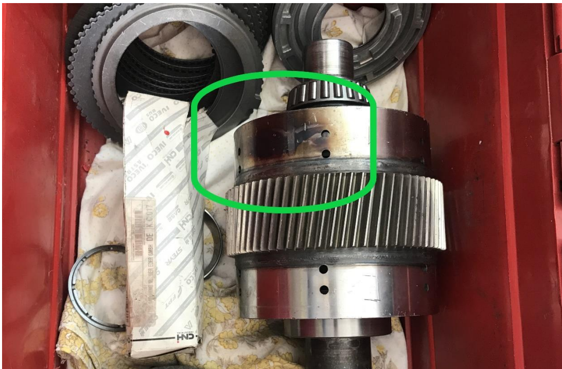
Obrázek 4.10: Změna barvy kovu u vyhřáté lamelové spojky z převodovky RCshift
