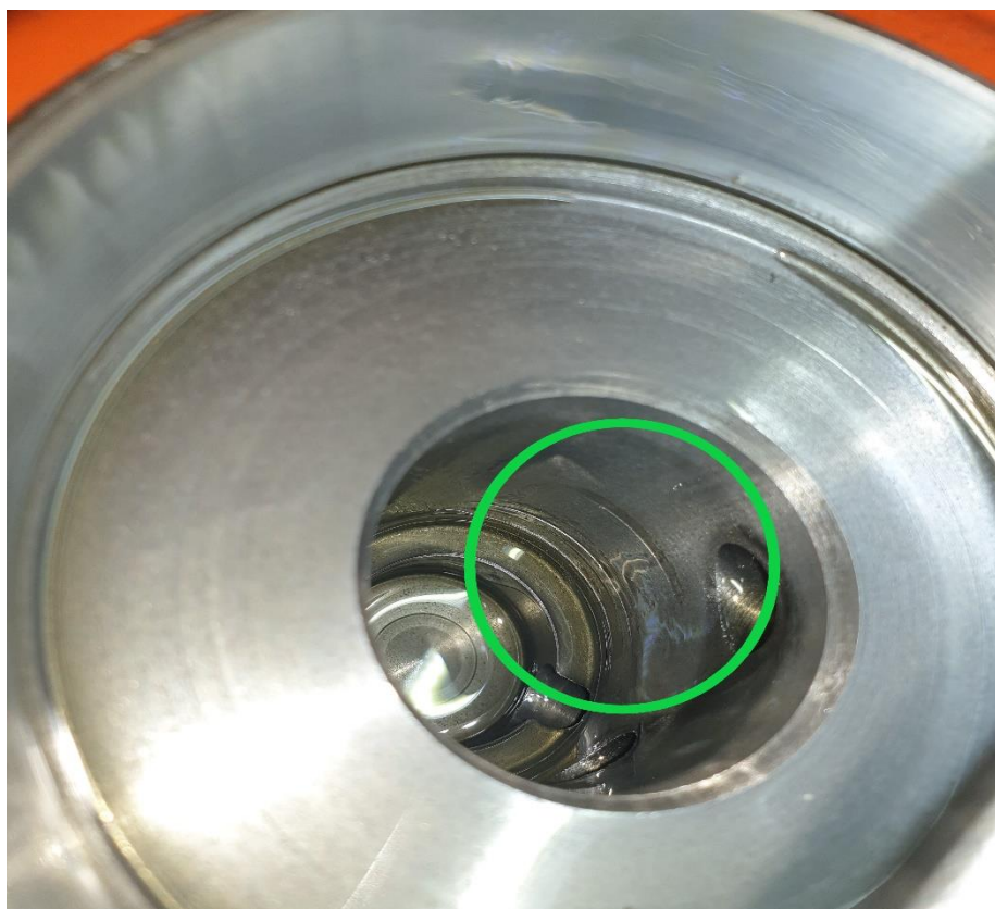
Obrázek 4.8: Vydřený domeček v bloku převodovky
