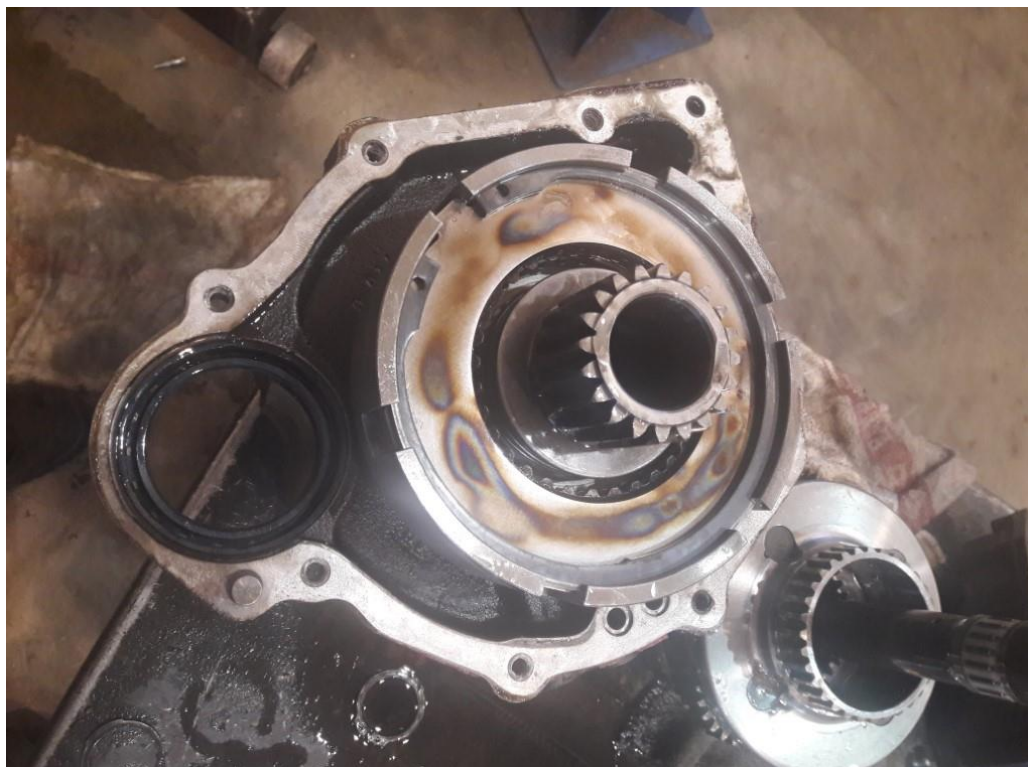
Obrázek 4.5: Vyhřátá lamelová spojka Powershift
