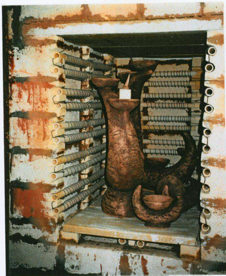
Obr. 16: Svícny v elektrické peci připravené k výpalu
