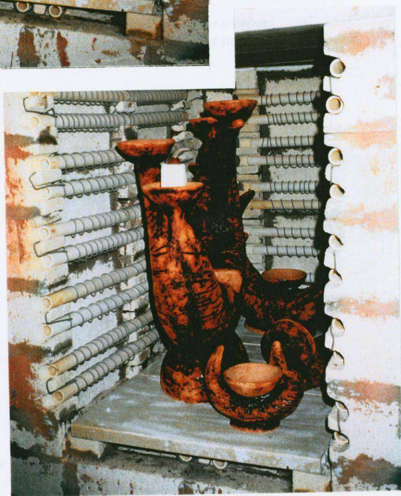
Obr. 16: Svícny v elektrické peci připravené k výpalu
