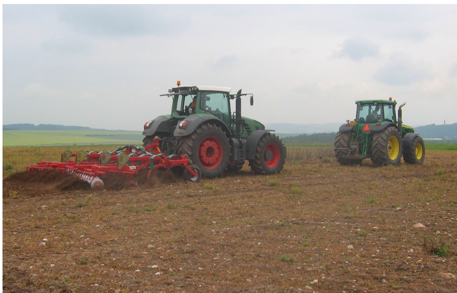
Obrázek 3 – Měření tahové síly.
